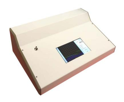
MSG-NIBP 无创血压模拟仪是一种模 拟无创血压波形,用于检测无创血压计和监 护仪性能的仪器。7寸 TFT LCD 触摸屏, 内置气泵可以产生高达 400mmHg(53.3kPa)的压力,内置婴儿和 成人袖带。模拟仪能够提供压力泄露测试, 压力释放测试,压力源测试,压力表测试, 标准血压模拟,病人状态模拟,心律失常模 拟,呼吸干扰模拟,新生儿模拟,腕式袖带 模拟,可以快速、准确的分析无创血压计和 监护仪的各项性能。血压模拟可实现心率 30~300BPM 和容积 0.1~2.4cc 内的任意 参数组合,并精确模拟心跳波形。
